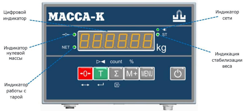
Передняя панель терминалов АВ и АВ(RUEW)
