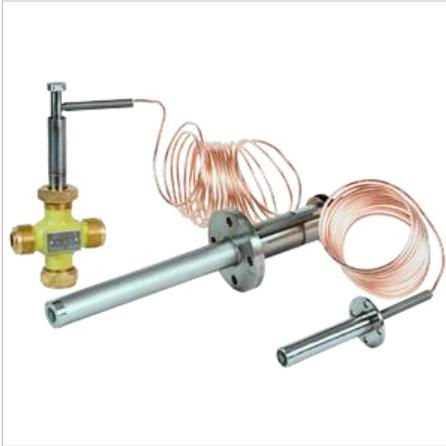
Регуляторы температуры прямого действия 2РТ, 2РТ2 предназначены для автоматического регулирования температуры воздуха на выходе систем кондиционирования воздуха путём изменения расхода рабочей среды через теплообменный аппарат.
