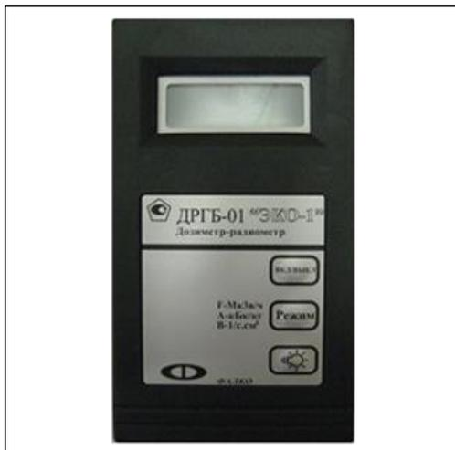
Дозиметр-радиометр ДРГБ-01 ЭКО-1 предназначен для измерения мощности амбиентного эквивалента дозы фотонного излучения, плотности потока бета-частиц, а также поиска и локализации радиоактивных источников.
