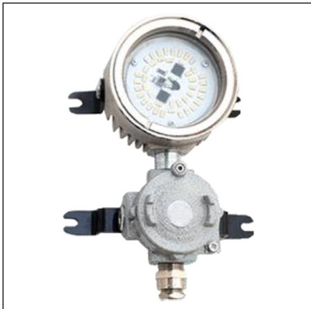
Взрывозащищенные малогабаритные светодиодные светильники СГУ05 предназначены для уличного монтажа и освещения открытых территорий, где возможно присутствие взрывоопасных сред. Светодиодные светильники состоят из корпуса, светодиодной матрицы и специального термостойкого ударопрочного полимерного стекла.
