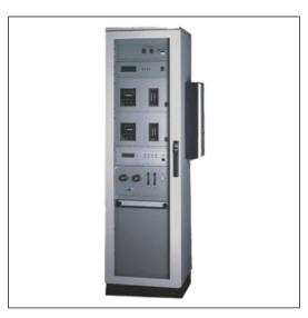
Газоаналитический комплекс СГК-10М предназначен для измерения NOX, SO<sub>2</sub>, CO, CO<sub>2</sub>, O<sub>2</sub>, (t, P) в любой комбинации. Работающий в автоматическом режиме, СГК-10М рассчитан на анализ газовых смесей сложности: большим содержанием пыли, влаги, агрессивными примесями, до и после газоочистки.
