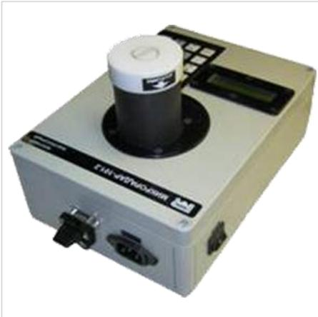
Лабораторный влагомер МИКРОРАДАР-101 предназначен для экспрессного измерения влажности сухого молока, казеина, сахара, полимеров и других материалов с влажностью от 0 до 20 % в лабораторных и цеховых условиях.
