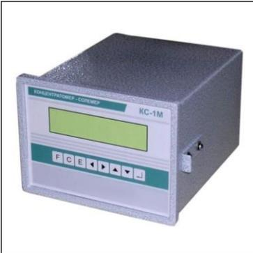
Прибор предназначен для непрерывного измерения удельной электрической проводимости (УЭП) и температуры жидких сред с последующим преобразованием в значение концентрации вещества в соответствии с заранее заданной зависимостью. Применяется для определения суммарного солевого содержания в природной, технической и котловой воде, концентрации кислот, солей, щелочей.
