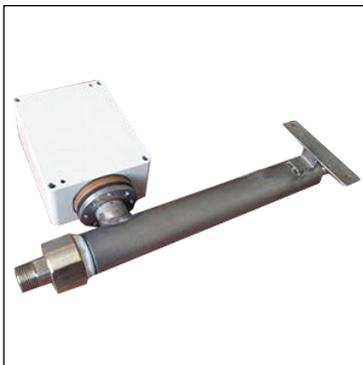
Прибор проточного исполнения выпускается в модификации: КС-1м-2 – одноканальный с 4-х электродным ПП с диапазоном измерения от 50 до 100000 мСм/м и температурой измеряемой среды от 0 до 100 °С.
