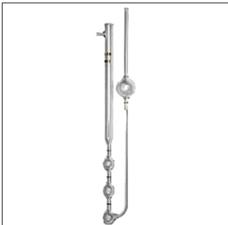
Вискозиметр капиллярный стеклянный типа ВНЖ предназначен для определения кинематической вязкости непрозрачных жидкостей (какими чаще всего являются нефти). В вискозиметрах типа ВНЖ производятся измерения не времени истечения жидкости по капилляру, а измерения времени заплнения жидкостью приемного резервуара (сначала нижнего, затем верхнего). Это вискозиметры обратного тока.
