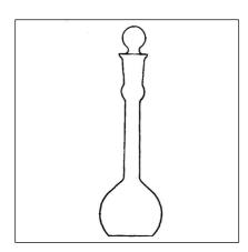
Пикнометр **ПЖ-2-25 КШ 10/19** предназначен для определения плотности жидкостей. Плотность жидкостей определяется по разности весов пустого пикнометра и пикнометра, заполненного до метки на горловине.
