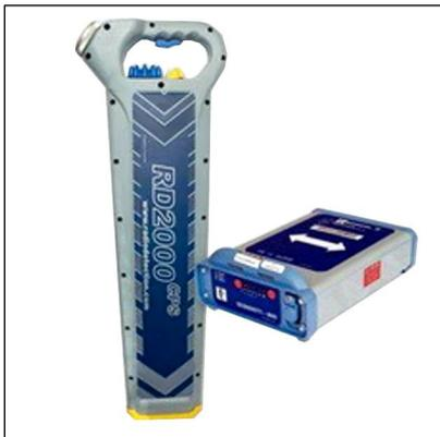
Трассоискатель **RD2000** предназначен для поиска и локализации газопроводов, нефтепроводов, электрокабелей, кабелей связи, оптоволоконных кабелей, водопроводов, канализации и определения глубины их залегания, не превышающей 3 метров с погрешностью  $\pm 5\%$  от значения глубины. Прибор обеспечивает высокую точность локализации –  $\pm 10\%$  от значения глубины.
