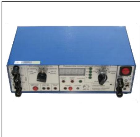
Измеритель сопротивления обмоток ИСО-1 является переносным прибором, предназначенным для измерения методом амперметра-вольтметра сопротивления цепей постоянного тока, в том числе цепей, имеющих значительную индуктивность (например, обмоток трансформаторов). Прибор подключается к измеряемой цепи по четырехпроводной схеме.
