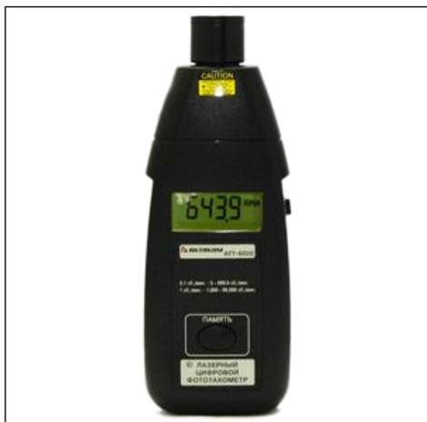
Портативный цифровой фототахометр с лазерным указателем предназначен для точного бесконтактного измерения скорости вращения в труднодоступных узлах и агрегатах, а также для измерения угловых скоростей валов с малым инерционным моментом.
