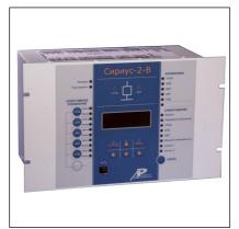
Устройство Сириус-2-В предназначено для выполнения функций релейной защиты, автоматики, управления и сигнализации ввода напряжением 3-35 кВ.
