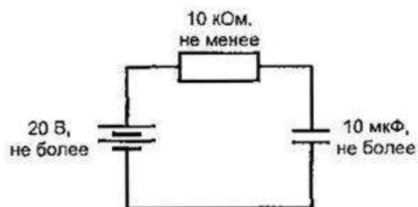
Рисунок А.24. Простая емкостная цепь
