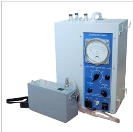
Аспиратор воздуха автоматический трёхканальный АВА-3 предназначен для отбора проб из больших объемов воздуха с целью определения содержания вредных веществ, находящихся в воздухе в малых концентрациях, в том числе тяжёлых металлов.
