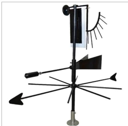
Флюгеры ФВЛ-М, ФВТ-М предназначены для определения скорости и направления ветра на метеорологических площадках.
