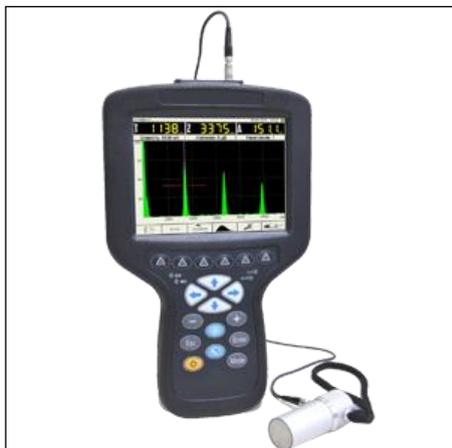
Ультразвуковой дефектоскоп A1220 ANKER предназначен для диагностики анкерных болтов диаметром от 20 до 40 мм фундаментов металлических опор контактной сети. Также прибор может быть использован для оценки состояния анкерных болтов фундаментов металлических прожекторных мачт.
