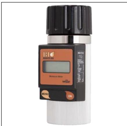
Влажмер Wile-BIO-Moisture-Wood предназначен для измерения влажности топливной древесины: древесных пеллет, опилок, полученных при пилении мотопилой, а также обычных опилок.
