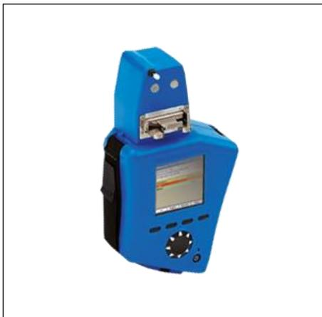
Инфракрасный анализатор Valtech Q-1100 обеспечивает прямое количественное измерение показателей масла, отвечающих за его состояние, и играет важную роль в профилактическом техническом обслуживании оборудования и управлении состоянием машины.
