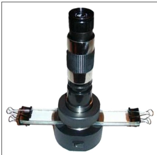
Портативный трихинеллоскоп ПТ-101 предназначен для диагностики трихинеллеза у диких и домашних животных методом компрессионной трихинеллоскопии. Может использоваться как обычный микроскоп. Все наблюдения производятся в проходящем свете.
