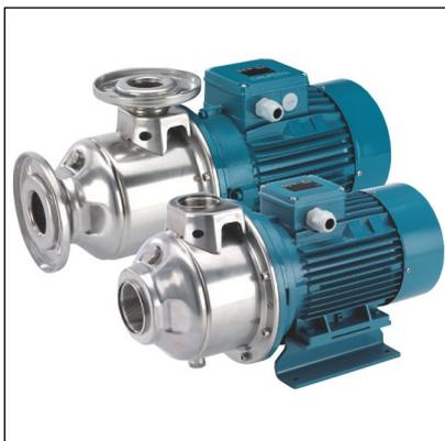
Насос моноблочный горизонтальный многоступенчатый **МХН** изготавливается из хромоникелевой стали. Конструкция насоса компактная и прочная, без выступающих фланцев и с монолитным соединением между насосом и двигателем с опорными ножками.
