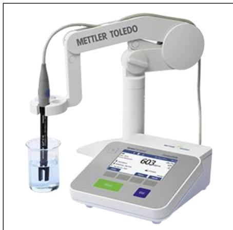
Прибор «S230-Kit» SevenCompact представляет собой стационарный кондуктометр с кондуктометрическим датчиком InLab 731-ISM для измерений проводимости в области средних и высоких концентраций в лабораторных условиях.
