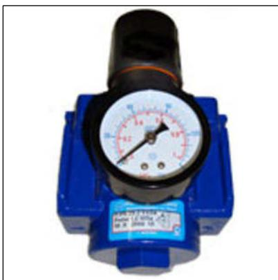
Редукционные пневмоклапаны «П-РК» с условным проходом (Ду)4;6;10;16;25мм с ручной настройкой давления на выходе, пружинной нагрузкой, с мембранным чувствительным элементом и стабилизированным дроссельным клапаном предназначены для понижения давления сжатого воздуха и поддержания его на заданном уровне в пневматических приводах различного назначения.
