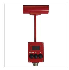
Анемометр акустический АПА-1/2 предназначен для постоянных измерений скорости воздуха и передаче информации в сеть по стандартным интерфейсам RS232, RS485, токовая петля (4-20), есть вариант подключения к PC по USB.
