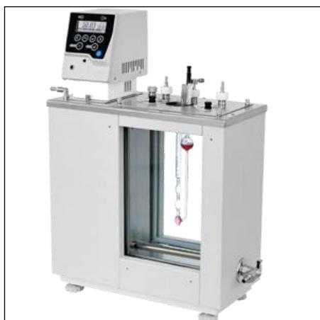
Жидкостные переливные термостаты с прозрачными стенками ВИС-Т-08-3 и ВИС-Т-09-3 предназначены для поддержания заданной температуры при проведении измерений вязкости нефтепродуктов с помощью стеклянных вискозиметров в соответствии с ГОСТ 33, ГОСТ Р 53708, ASTM D445, IP 71, ISO 3104 и DIN 51366.
