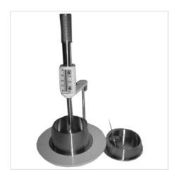
Прибор ВИКА ИВ-2 предназначен для определения нормальной густоты, сроков схватывания и определения толщины корки цементного теста.
