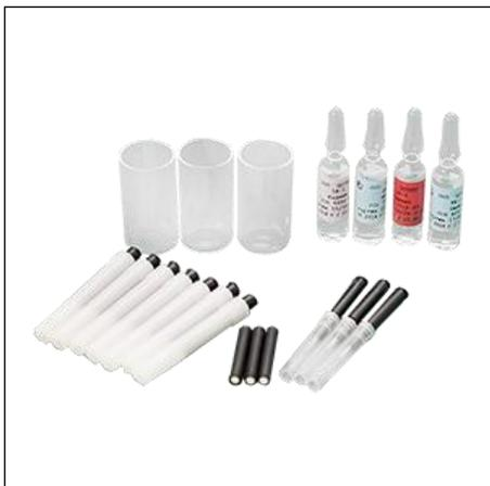
Комплект содержит комплектующие, необходимые для определения цинка, кадмия, свинца и меди методом инверсионной вольтамперометрии на анализаторе вольтамперометрическом TA-Lab.
