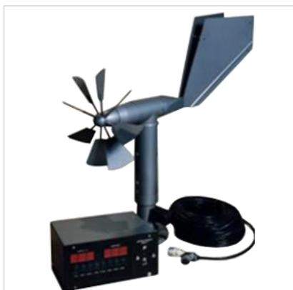
Анеморумбометр М63М-1 предназначен для дистанционного измерения мгновенной, максимальной и средней скоростей и направления ветра. Исполнение анеморумбометра с выходом на компьютер позволяет производить выдачу результатов измерения по интерфейсу RS-232 в виде таблиц, графиков, розы ветров.
