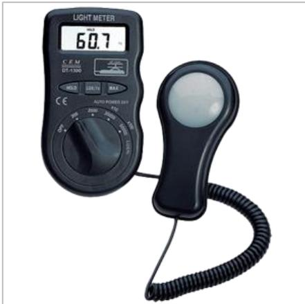
Прибор DT-1301 предназначен для измерения уровня освещения в диапазоне 0...50000 Lux.
