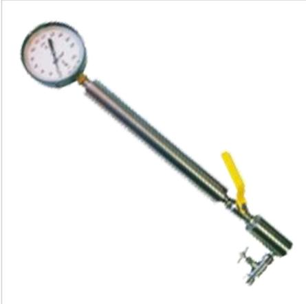
Бомба Рейда предназначена для измерения давления насыщенных паров летучей сырой нефти и летучих невязких нефтепродуктов, кроме сжиженных нефтяных газов.
