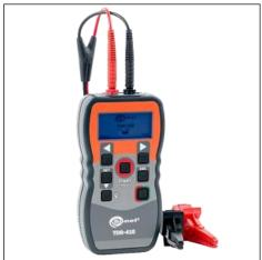
Цифровой импульсный локализатор TDR-410 предназначен для идентификации и локализации повреждений в силовых, телекоммуникационных и телефонных кабелях.
