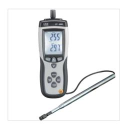
Термоанемометр DT-8880 предназначен ДЛЯ измерения температуры и низких скоростей воздушного потока: 0,1 – 25 м/с.
