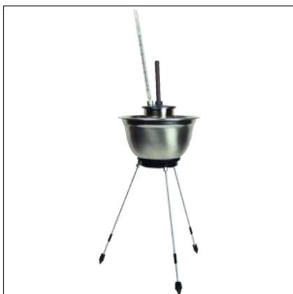
Вискозиметр Константа-В3-1(2,5; 5,4) предназначен для определения условной вязкости (времени истечения) лакокрасочных материалов и относящихся к ним продуктов – ньютоновских или приближающихся к ним жидкостей.
