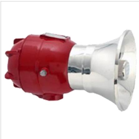
Пост звуковой сигнализации ПГЗ-РЕВУН4 представляет собой прибор с возможностью удаленного выбора режима звучания предназначен для непрерывной круглосуточной работы в дежурном режиме, обеспечение возможности выдачи 4 видов звуковых сигналов сигнализации, (прерывистый, двух тональный, плавно нарастающий и постоянный) в охранной, пожарной и других системах сигнализации.
