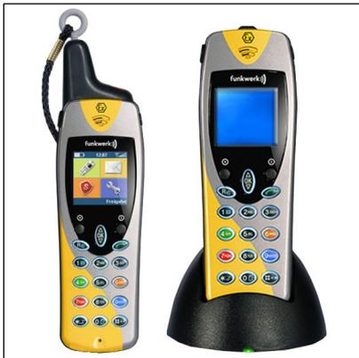
Промышленный взрывозащищенный телефон нового поколения **FC4 Ex** на базе стандарта DECT со встроенным устройством передачи речи и данных является успешной новой модификацией серии FC1, телефоны серии FC4 органично вписываются во все существующие системы DECT компании.
