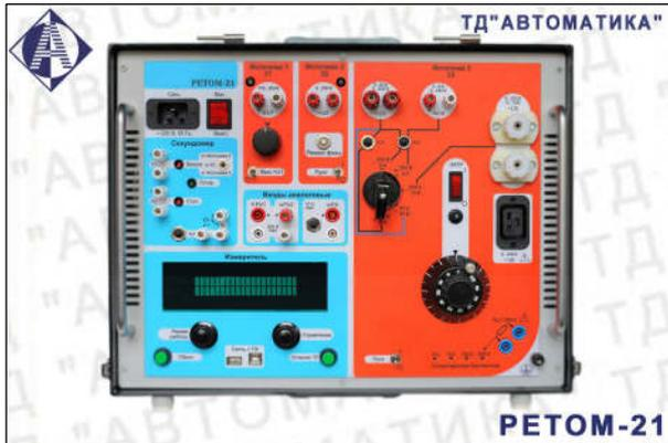
Испытательный прибор РЕТОМ-21 является базовым прибором испытательного комплекса для проверки первичного и вторичного электрооборудования. По сравнению со своим предшественником РЕТОМ-11М он обладает целым рядом существенных преимуществ:
