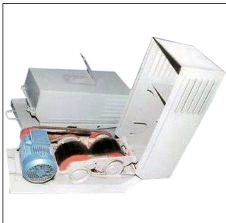
Валковая дробилка ДГ 200x125А предназначена для мелкого дробления горных пород и других материалов с пределом прочности которых не превышает 250 Мпа (4000 кгс/см<sup>2</sup>).
