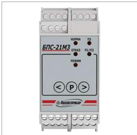
Блоки питания и сигнализации БПС-21М3 предназначены для измерения входного сигнала постоянного тока (в том числе искробезопасного), а также для формирования, в том числе искробезопасного, напряжения питания датчиков-сигнализаторов ДАТ-М, сигнализаторов СТМ-30, датчиков-газоанализаторов ДАХ-М, ДАК, ДАМ, анализаторов активности ионов потенциометрических АП430-02 и иных совместимых устройств.
