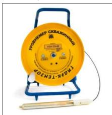
Уровнемер предназначен для измерения глубины залегания уровня воды в наблюдательных гидрогеологических, эксплуатационных и других обсаженных металлическими трубами скважинах или пьезометрах путём опускания в скважину электрода на мерном тросе.
