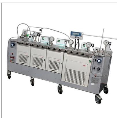
Вторичные эталоны предназначены для воспроизведения температуры точки росы по воде и углеводородам по методу фазового равновесия и передачи ее размера эталонным и рабочим средствам измерений точки росы.
