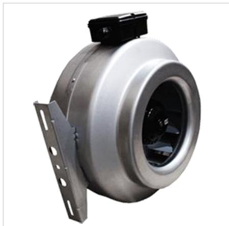
Вентиляторы канальные круглые ВКК предназначены для работы в составе канальных систем вентиляции и служат для генерации приточного или вытяжного воздушного потока вдоль воздуховодов. Вентиляторы канальные в оцинкованном корпусе данного типа устанавливаются непосредственно в сечение воздуховодов и не занимают много места.
