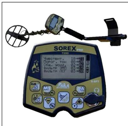
Селективный вихретоковый металлодетектор **Сорекс PRO** с индукционно компенсированным преобразователем (датчиком) является старшей профессиональной моделью в серии приборов «Сорекс».
