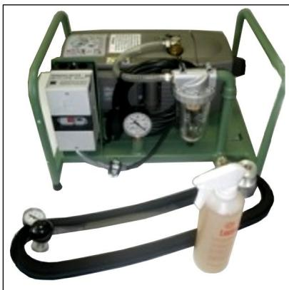
Вакуумный течеискатель **KOWOVAC-VSP-1TS** предназначен для контроля герметичности сварных швов в резервуарах, трубопроводах и иных сварных конструкциях с помощью пенообразующего раствора. Течеискатели можно применять также для контроля литьевых изделий на наличие сквозных дефектов (трещин, пористости).
