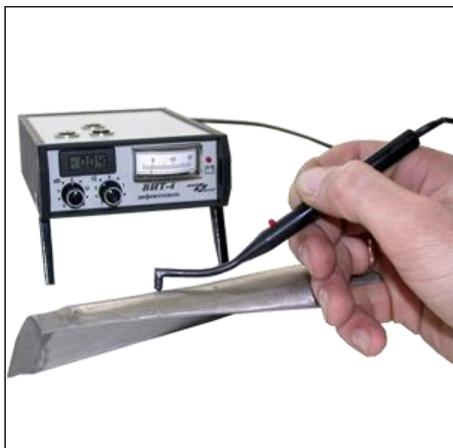
Дефектоскоп вихретоковый ВИТ-4 предназначен для обнаружения и оценки глубины поверхностных трещин на изделиях из электропроводящих ферромагнитных и неферромагнитных материалов.
