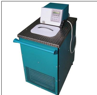
Термокриостат жидкостной **ТКС-20 ЛинтеЛ** предназначен для точного поддержания заданной температуры в любом оборудовании, работает в комплекте с аппаратами ДБ-2М, ДБ-150, ДБ-20-150, ПН-10Б, ПН-20Б, АТХ-20, АРНС-20, Кристалл-10Э, Кристалл-10Н.
