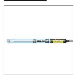
Стеклянный промышленно-лабораторный натрий-селективный электрод для анализа малых концентраций. Предназначен в составе специальных анализаторов, например pNa-205, для измерения активности ионов натрия в химически обессоленной воде и конденсате пара котлов высокого давления.
