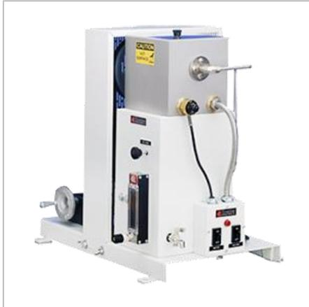
Аппарат для определения характеристик вымывания водой. Состоит из резервуара, гнезда размещения подшипника, системы циркуляции и приводящего двигателя. Резервуар имеет каналные нагреватели, регуляторы температуры и гнездо для чёткого контроля температуры.
