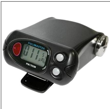
Предназначены для поиска и локализации радиоактивных источников и измерения мощности эквивалентной дозы (МЭД).
