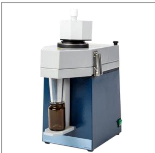
Лабораторная мельница Циклотек-СТ-193, производящая однородные частицы, предназначена для быстрого, однородного измельчения самых разнообразных сортов кормов, зерна, листвы и так далее, а также для измельчения реагентов, фармацевтических препаратов и подобных продуктов.
