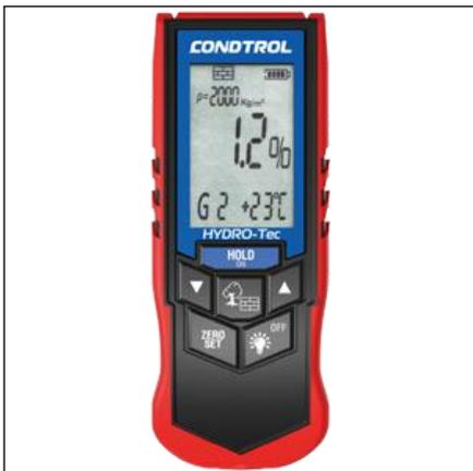
Влагомер строительных материалов CONDROL-HYDRO-Тес предназначен для оперативного измерения влажности древесины и строительных материалов (бетон, растворная стяжка, штукатурка, кирпич).
